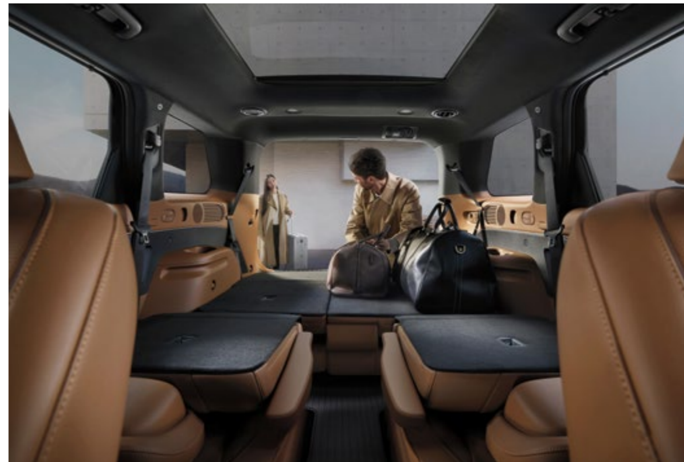
Дистанционное складывание сидений второго и третьего рядов
