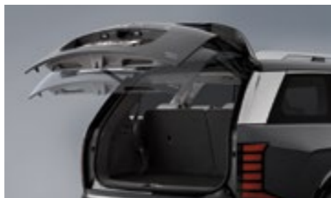
Интеллектуальная система открывания багажника (с регулировкой высоты)
