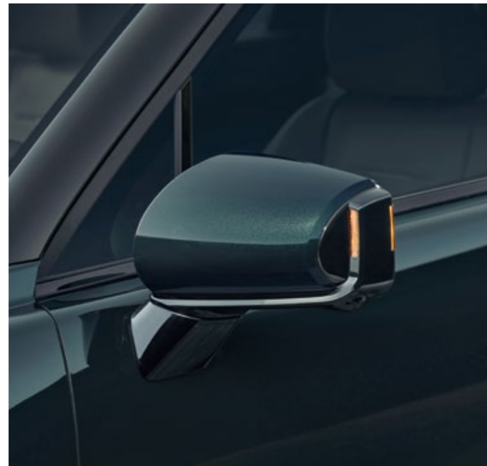
Боковые зеркала со светодиодными повторителями указателей поворота
