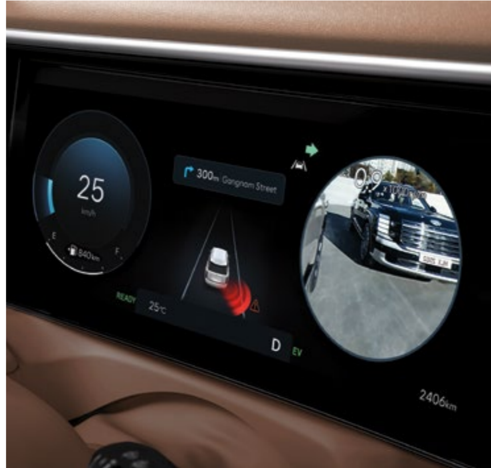
Система мониторинга слепых зон (BSM)
